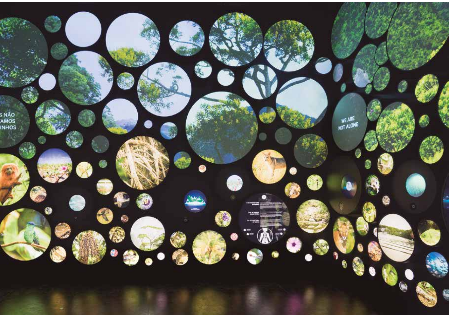
Nesta página, na parte interna do cubo "Vida", ainda no segmento Terra, a iluminação é composta de projeções de vídeo na parte superior das paredes e iluminação backlight por meio de módulos de LED 63lm 4.000K IRC80 na parte inferior. No cubo "Pensamento", painéis iluminados por meio de backlight por projetores de fecho simétricos de 14º para LED 4.000K 56lm. Na imagem seguinte à direita, a área do "Antropoceno" da exposição permanente, traz totens gigantes com painéis de LED multimídia, montados no lado interno dos totens, e iluminação tipo backlight na sua base, em espaço chamado de caverna
