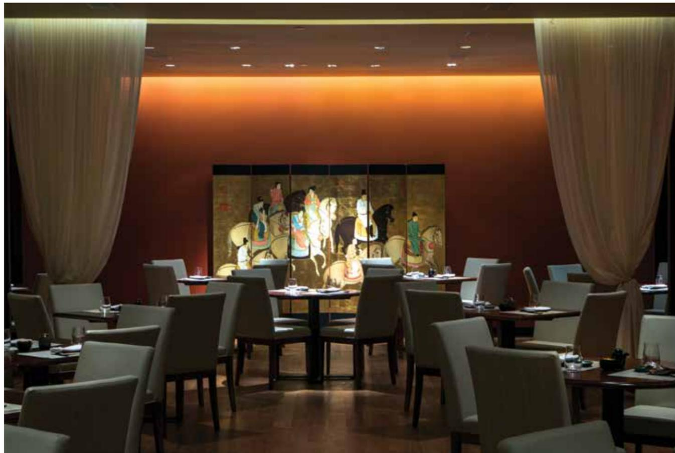
Na página oposta, acima, no primeiro plano, o salão com iluminação geral de halógenas MR 16 com abertura de 60° e grelhas antiofuscamento. No segundo plano, fundo do salão com mesas recebe iluminação focada de halógenas MR 16, com abertura de 24°. Demais fotos: o projeto tem diferentes transparências, com ripados, cortinas e bolhas translúcidas
